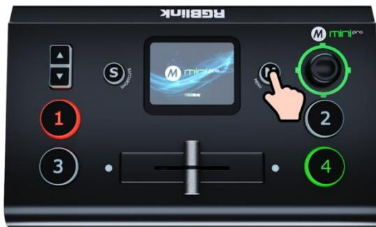
如下图所示，mini-pro 的 2 寸触摸全彩显示屏的风格和目前主流的手机操作界面相似，一级菜单都是图标按键，通过轻触相应的图标可以快速进入相应的功能管理界面。
