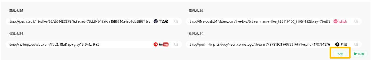
4. 打开推流界面或快捷界面的推流开关即可开启推流。在推流过程中，用户可以中途打开或关闭其中任一流地址来打开或关闭某一平台的推流。开启推流后，推流成功的地址栏在界面上会显示为绿色常亮。未推流成功的地址栏会闪烁绿光。
