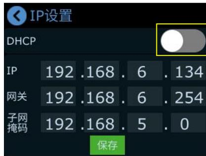
**静态：**若不使用 DHCP 分配 IP 功能，用户可以手动设置静态 IP。关闭 DHCP 开关，用户可手动设置 IP 地址。
