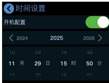
3. 若开启**开机配置**，mini-pro 在开机后界面会自动弹出此界面以提醒用户进行时间设置。设备关机后，设置的时间将恢复为默认值。
