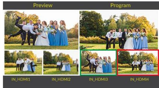
HDMI 多画面输出除了支持多画面监看外，还支持选择固定输出某一路输入信号或者直接选择主输出的信号，您可以通过菜单里面的输出设置进行 PVW 和 PGM 的切换与各个输入信号之间的切换。
