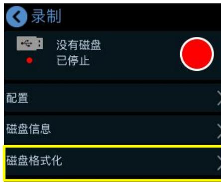
2.3 插入U盘后，先将U盘进行格式化：在Windows电脑上将文件系统设置为“exFAT”，将分配单元大小设置成128kb > 点击“磁盘格式化” > “是”，即可完成磁盘格式化操作。
