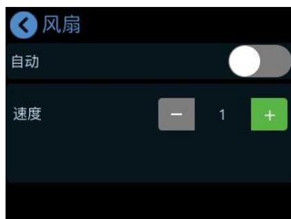
打开自动，设备便会自动调整风扇转速。关闭自动，便可手动调整风扇转速，转速支持四档可调。
