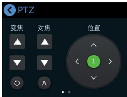
2. 转速调整：您可以通过直接点击位置调整中心的数字进行转速调整，PTZ 转速范围为：17,14,11,8,5,2。您也可以通过使用摇杆或轻触触摸屏速度调节区域来调整 PTZ 转速。
