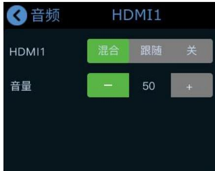
3. 在该界面，您可以调整 HDMI 1/HDMI 2/HDMI 3/HDMI 4 音频（嵌入音频）的音量等级。
