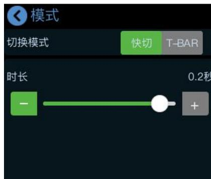
3. mini-pro 支持**T-BAR 切换模式**。对于一些重要的场合，为确保画面的准确与稳定，您可选择 T-BAR 预览模式，即在预览窗口对下一个即将切换出去的场景进行预览和编辑，确认画面后，滑动 T-BAR，进行 PVW 和 PGM 的相互切换。
