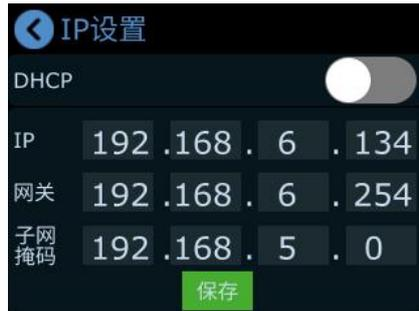
打开 DHCP 开关，设备可自动获取 IP 地址，关闭 DHCP 开关可手动配置 IP 地址，子网掩码和网关。
