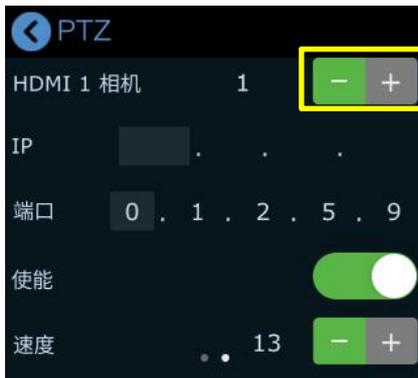
4. 在使用 mini-pro 控制摄像机功能之前，用户需要先检查摄像机的端口号是否为 1259（推荐使用 RGBlink vue 系列广电级摄像机），若非 1259，请先查阅摄像机的说明书，再在此界面输入摄像机对应的端口号以确保后续的正常使用的。
