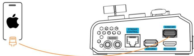
2) 连接手机和 mini-pro 后，手机将出现提示语“是否信任该设备”，选择“信任”并按以下步骤输入无线密码：打开“设置”> 点击“个人热点”> 输入“无线局域网密码”并打开“个人热点”。
