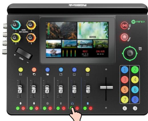
若点击左方的 HDMI / SDI 按钮，可对四路 HDMI 在主输出或预览输出通道上的音频实现统一管理，打开则四路 HDMI / SDI 在对应通道上全部静音。
