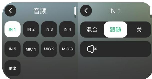
轻触 MIC 1,MIC 2,MIC3 IN1、IN2、IN3、IN4、IN5 可对其输入音频进行更详细的设置。HDMI 输入可以选择混合、音频跟随视频、关闭音频等
