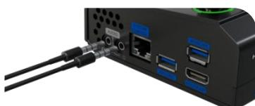
mini-ISO 具有两路音频输入，用户可连接麦克风至 MIC IN/LINE IN 接口。mini-ISO 具有一路音频输出，用户可连接音响或耳机至 AUDIO OUT 接口。
