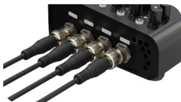
通过 SDI 连接线将 PTZ、摄像机等输入源连接至 mini-ISO 的 SDI IN 接口。
