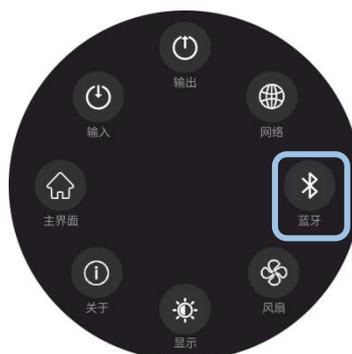
选择蓝牙图标进入蓝牙设置界面，通过左右滑动的方式打开 TAO 1mini-HN 的蓝牙。
