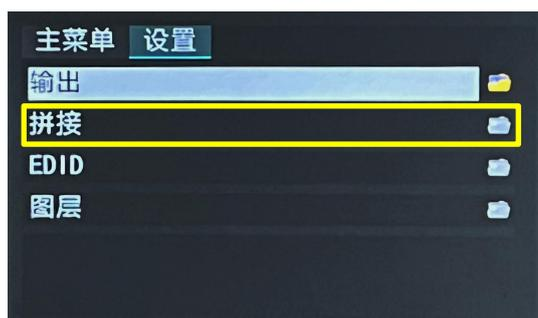
选择拼接布局，在参数设置界面根据实际需要输入屏幕总宽和屏幕总高等参数。设置完参数后，点击“保存设置”>“确认”便可保存。
