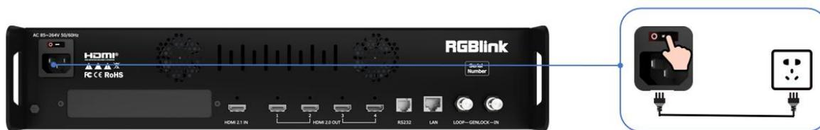
连接完电源、输入、输出源以后，将设备后面板上的电源开关按向 ON 的位置启动设备。
