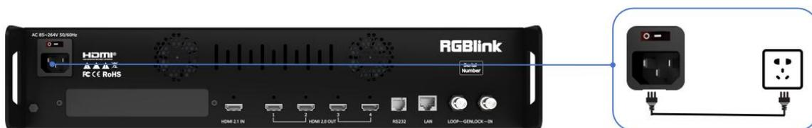
使用标配的电源线连接电源与 D8 设备。将电源线的一头接入设备的电源接口，另一头插入插座。
