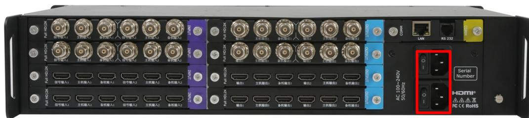
将电源线的一头接入设备的电源接口，另一头插入插座，并将插座的电源打开。DX8 采用冗余双电源设计，任意一个电源断电，设备仍可正常运行工作。用户可选择接入其中一个电源，若需冗余电源备份，则可同时接入两个电源。
