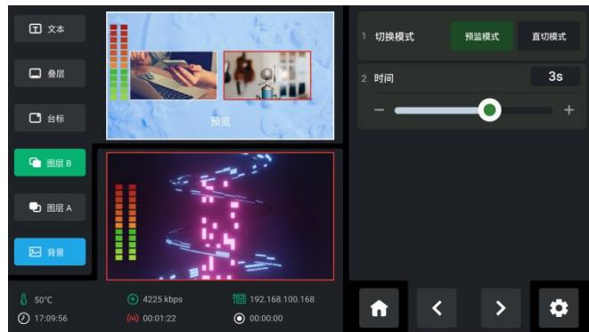
mini-mx 为用户提供了 2 种切换模式，即 **T-Bar 预监模式** 和 **直切模式**。用户可轻触对应图标选择切换模式。
