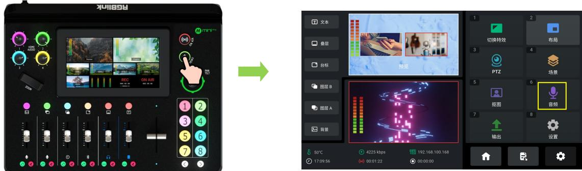
轻触【音频】或前面板的【6】号按键进入音频设置菜单。单击/双击/长按预监界面的音频状态监视区亦可进入下图所示的音频管理界面。音频管理界面将分为 8 个部分进行介绍，用户可参照如下表格进行操作。
