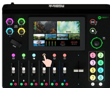
5. 与上述图层 A、图层 B 画面布局的设置一样，进入布局设置界面后用户可以选择布局。通过五向摇杆可调整台标的水平位置和垂直位置。
