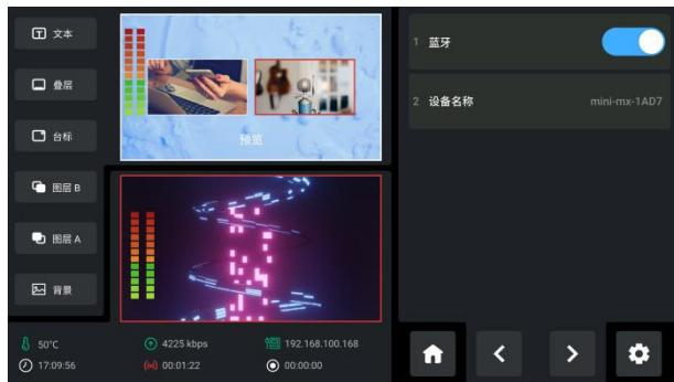
用户可选择开启或关闭蓝牙，蓝牙默认为开启状态。此外，该界面支持查看设备本机名称，当 mini-mx 在与其他设备，比如手机进行配对或建立蓝牙连接时，可在手机蓝牙设置界面查看已打开蓝牙的 mini-mx 设备(如本台 mini-mx 名称为 mini-mx-1AD7)，以便选择进行蓝牙连接的 mini-mx 设备。
