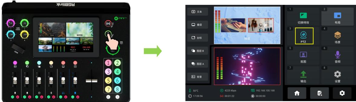
轻触液晶屏菜单的【PTZ】或前面板的【3】号按键进入 PTZ 配置与控制界面，如下图所示。
