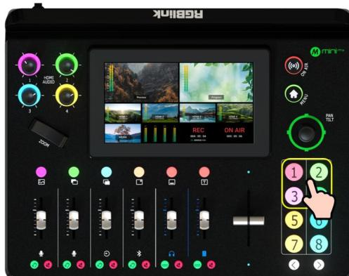
3. 选择完图层后，用户可以通过前面板的调焦器对图层进行缩放和裁剪，通过五向摇杆调整图层的水平位置和垂直位置。轻按五向摇杆可以一键满屏，再按一次五向摇杆可以恢复最后设置的大小和位置。
