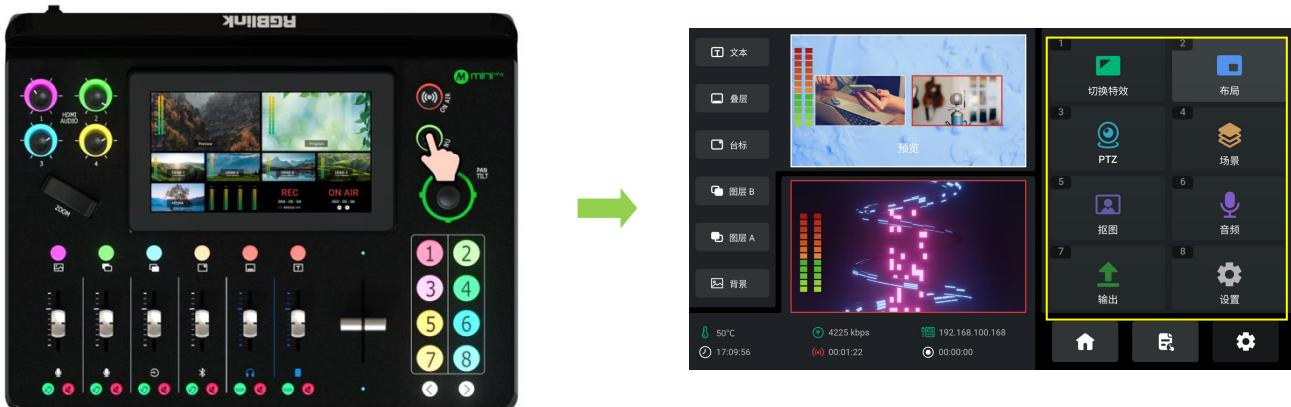
如上图所示，mini-mx 的 5.5 寸触摸全彩显示屏的风格和目前手机操作界面相似，一级菜单都是图标按键，通过轻触相应的图标可以快速进入相应功能管理界面。
