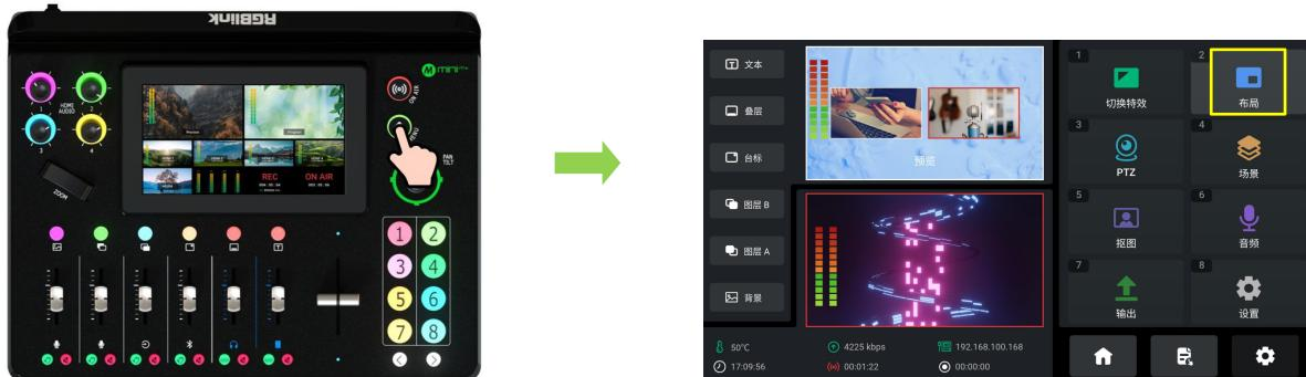
画中画布局能够在一个屏幕上同时显示多个窗口，允许用户同时查看多个视频内容。用户可以将画中画视频作为一个嵌入窗口，显示在 PGM 主输出窗口上。如下图所示，共 7 种画中画布局可选，其中布局【7】为左右双图层布局，若选择此布局，用户可以使用调焦器同步调节左右画面的比例以实现画面的同时变化。
