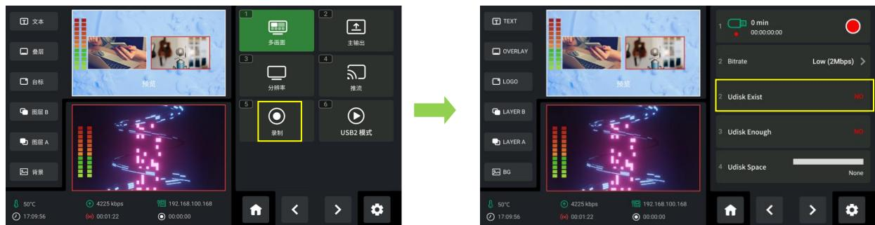
插入 U 盘后，先将 U 盘进行格式化：在 Windows 电脑上将文件系统设置为“exFAT”，将分配单元大小设置成 128kb >点击格式化 U 盘 > 确认，即可完成 U 盘格式化的操作。
