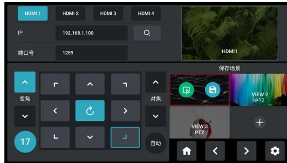
mini-mx 支持同时控制 4 台摄像机。在使用 mini-mx 控制摄像机功能之前，用户需要先检查摄像机的端口号是否为 1259（推荐使用 RGBlink vue 系列广电级摄像机），若非 1259，请先查阅摄像机的说明书，再在此界面输入摄像机对应的端口号以确保后续的正常使用。
