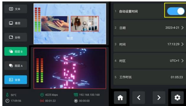
若设备未连接网络，用户需要手动进行时间设置，设备将保存设定时间并开始自动计算。
