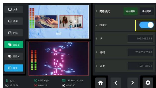
静态：若不使用 DHCP 分配 IP 功能，用户可以手动设置静态 IP。关闭 DHCP 开关，用户可手动设置 IP 地址。设置完毕，点击确认进行保存。
