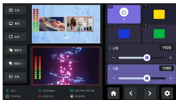
选择完背景颜色后，您可通过五向摇杆选择上限、下限以及边缘，使用滑轨或前面板的调焦器对抠图参数进行调整。mini-mx 默认抠图参数为：上限 1232，下限 560，边缘 200。
