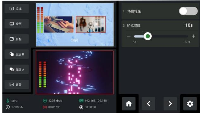
场景轮巡，即将已保存的场景进行循环切换，以便用户可以同时查看多个画面。打开场景轮巡开关后可设置轮巡间隔的时间，若设置轮巡间隔为 10 秒，每个场景显示 10 秒后，将会自动跳转到下一个场景依次循环播放。轮巡到最后一个场景后将会自动跳转到最前面的场景，循环轮巡。
