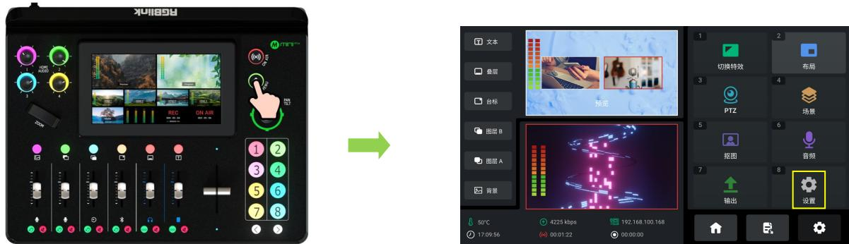
轻触菜单界面的【设置】或前面板的【8】号按键进入设置菜单。您也可以通过轻按 图标快速进入设置界面。如下图所示，设置区菜单包括 11 个部分的功能：**关于**，**日期和时间**，**语言**，**网络**，**蓝牙**，**场景轮巡**，**T-Bar 模式**，**工厂复位**，**自动返回**，**风扇**以及**显示**。
