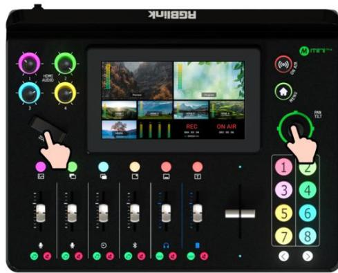
4. 长按图层选择键中的图层 A/图层 B/台标/叠层按键可进入布局选择界面。用户也可以轻按菜单界面的【布局】图标或前面板的【2】号按键进入该界面。如下图所示，共 7 种布局可选，选择完布局，图层 A 将按照该布局在背景上显示。点击选项【8】，您还可以设置图层缩放和裁剪的具体参数。
