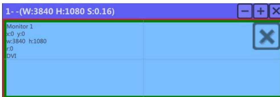
**自定义输出分辨率（已创建）：**点击模版下方自定义
