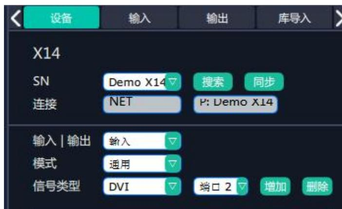
3. 拖入 X14 设备后，点击“搜索”
