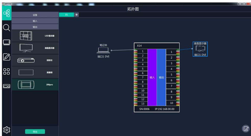
从左侧设备列表里拖出需要的处理器设备，输入设备，输出设备（鼠标左键按住，拖拽到右侧空白区域）
