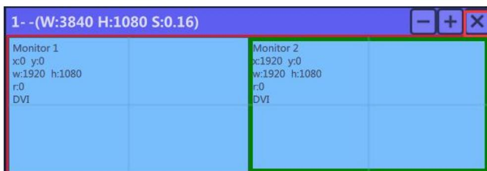
设置显示器的显示分辨率和位置：使用界面正下方的横条，手动输入
