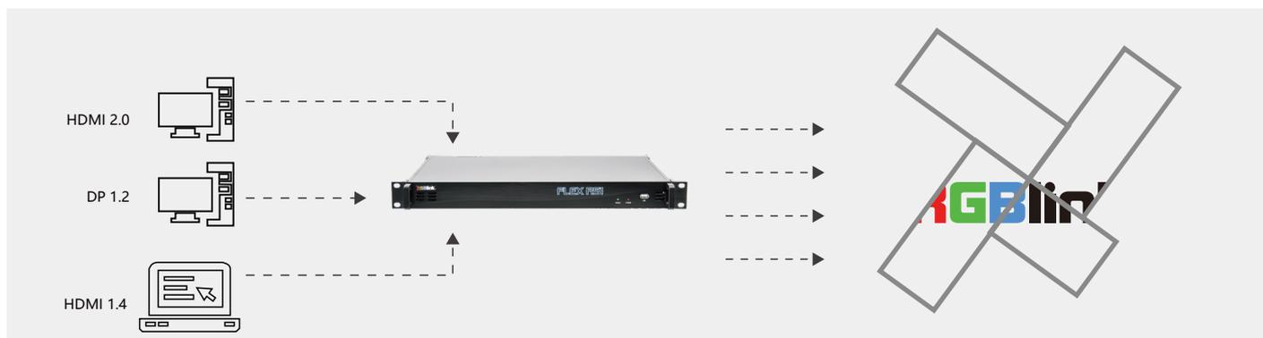
每路输出可以进行独立的参数设置，从而支持多个不同尺寸的显示器进行组合拼接显示。
