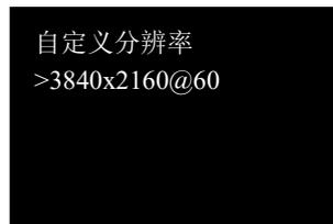
按下旋钮, 分辨率前的>变成\*, 使用前面板上数字键输入宽度值, 按下旋钮确认, 宽度值设置完成依照同样方法依次输入高度值和帧率。
