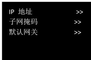
使用旋钮调整数值，可以设置 IP 地址，子网掩码和默认网关。
