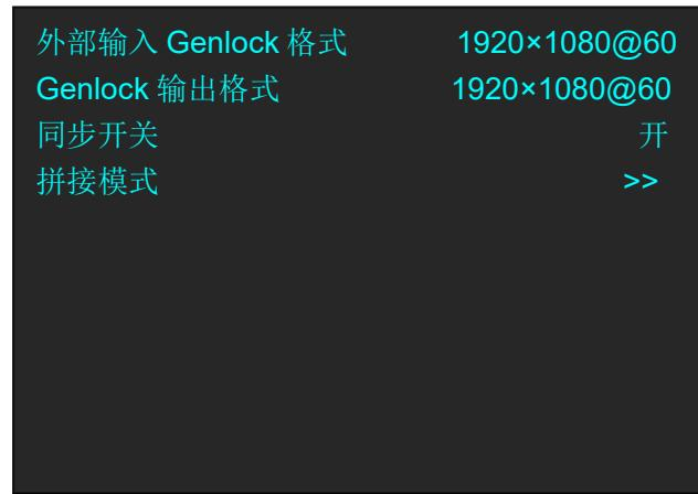
多机级联的操作如上节“拼接模式”，但菜单项中没有多画面的布局只有基本的背景拼接模式。
