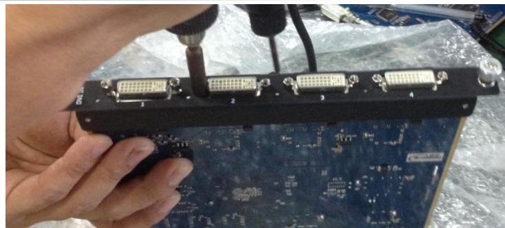
4. 将输入板卡模块沿滑轨条推到机子里面，并将松不脱螺丝拧紧，如下图：
