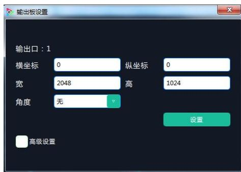
用户可以对输出板进行位置、尺寸及角度调整等操作，设置完成后，点击“**设置**”进行确认。
