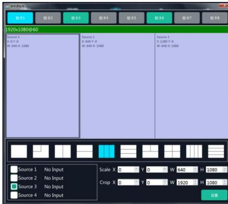
点击任意图层，再点击信号源，可进行图层信号源切换，如下图所示：
