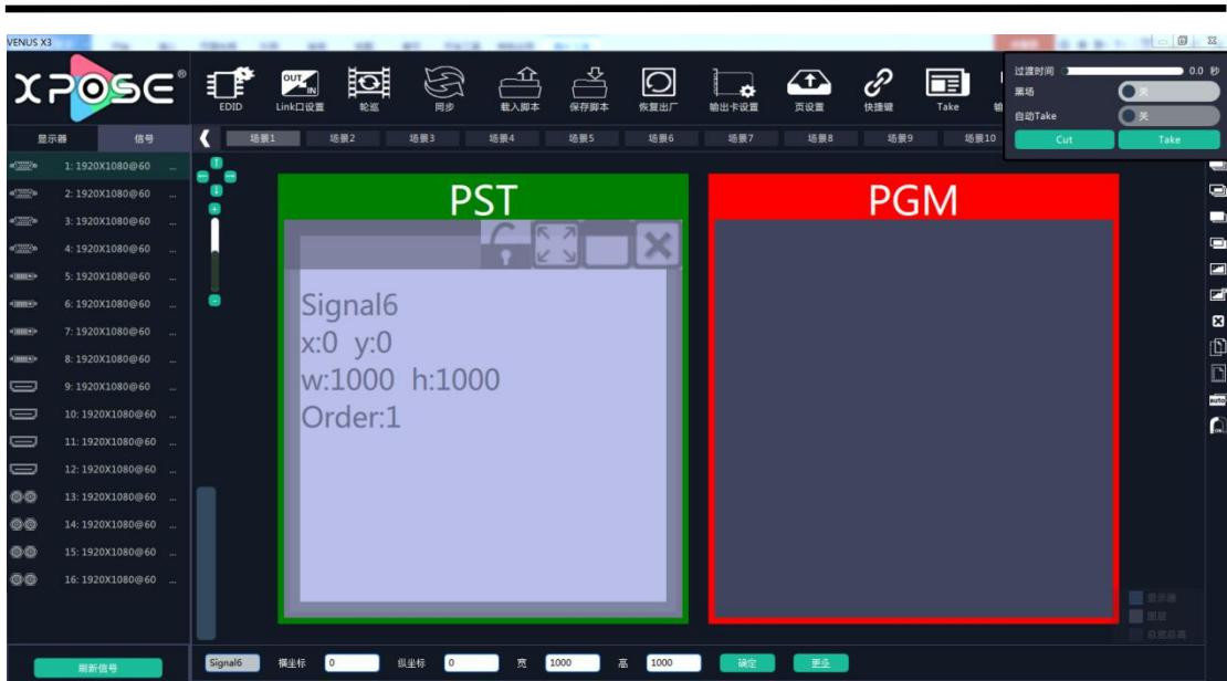
使用 Link 模式，需要进行物理连接，将输出口 6 和 8 用环路连接到任意两个相同信号或者可兼容信号的输入口。例如，DVI 输出连接到 DVI 输入口或者通过转接头连接到 HDMI 输入口，HDMI 输出连接到 HDMI 输入口或者通过转接头连接到 DVI 输入口，但是 SDI 输出只能
