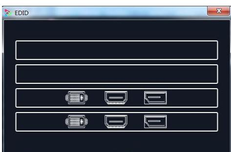
点击输入口后，用户可进行宽度、高度及频率设置，设置完成后，点击“设置”进行确认。若因操作不当，可点击“重置”进行重新操作。
