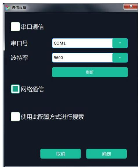
用户可以选择串口通信或网络通信。不选择“使用此配置方式进行搜索”选项，软件在搜索设备时将遍历所有通信方式进行搜索。
