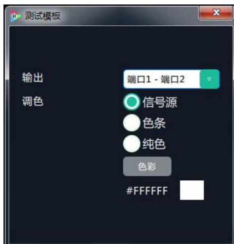
**输出：**选择所需测试的输出端口。
