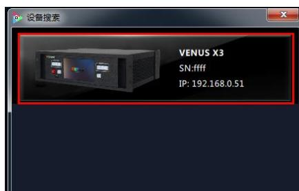
注：右击设备时，用户可设置标记名称，主要用于连接多台设备时，更直接地显示当前所连接的设备。若选择清除标记名称，当前设置标记被清除。
