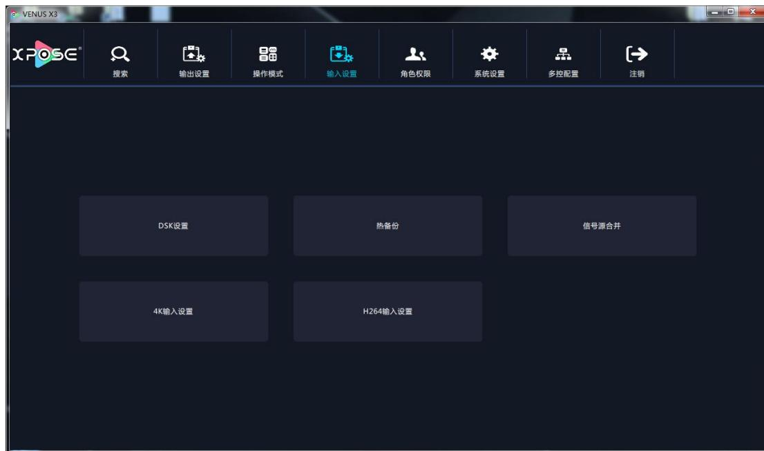
在输入设置中，用户可以进行 DSK 设置、热备份、信号源合并、4K 输入设置和 H264 输入设置，具体如下：
