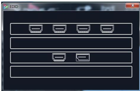
此处为 EDID 信息更改，用于自定义非常规分辨率输出。用户可选择输入板或者输出板，点击任意接口，进行 EDID 读、写及模板设置，设置完成后，点击“设置”进行确认，如下图所示：
