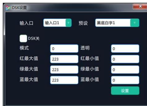
在 DSK 设置中，用户需要在 DSK 开关中打开 DSK 功能，如图： DSK开，再选择输入口进行设置，包括预设模式选择，自定义模式、透明度以及红绿蓝最大值和最小值设置。设置完成后，点击“设置”进行确认。
