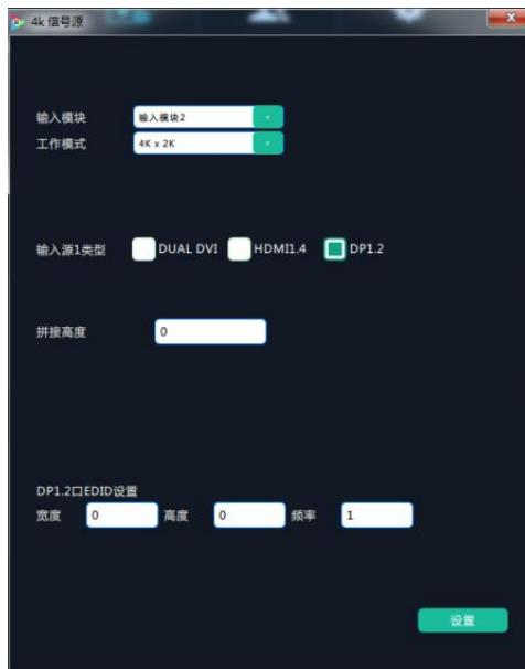
进入 4K 信号源对话框后，若连接有 4K 输入板，系统提示“读取 4k 输入信号源信息成功”，
