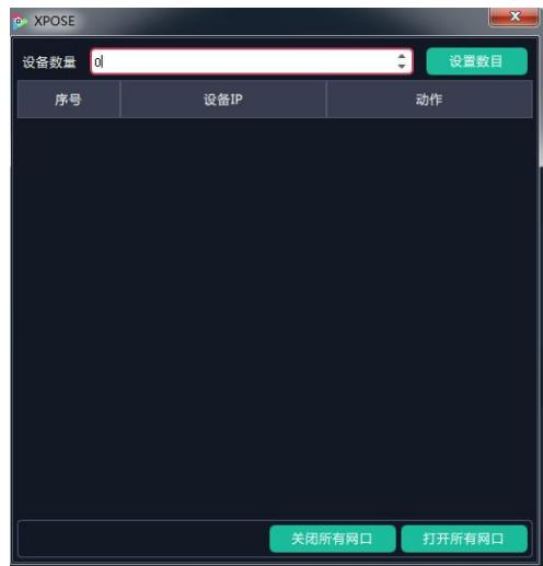
输入“设备数量”，点击“设置数量”，会出现连接在同一路由器上 X3 设备的 IP，可以一一
