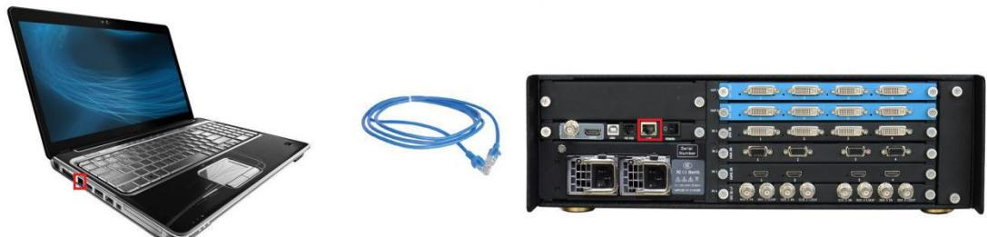
根据前面板 LCD 屏上显示的设备 IP 地址，设置电脑的 IP 地址，确保电脑和设备的 IP 在同一网段上，但电脑和设备的 IP 不能完全一样，否则会 IP 地址冲突。
