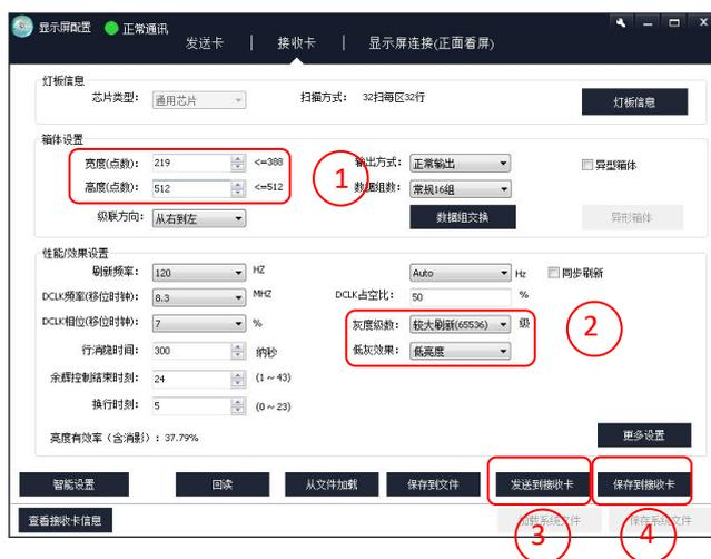
注：设置完第一张发送卡后，若要设置第二张发送卡，则您可在发送卡调试界面“当前发送设备”中选择设备 2，并点击“重新检查”，重复第一张发送卡的调试步骤即可。
