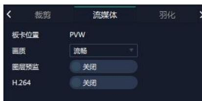
模块位置：显示流媒体 H.264 模块或者 PVW 板所在的位置，FLEXpro 8 上的 PVW 通过 1 个 HDMI 接口集成在通讯板上，可接扩展显示器直接监看 16 路输入源。
