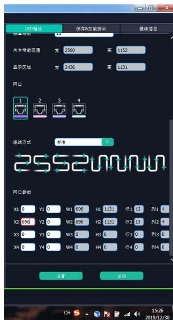
如何设置每个网口控制的 LED 屏区域，以下以设置设置第三个网口为例：
