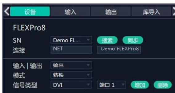
当拖入的 FLEXpro 8 设备后，可在 SN 的后面的下拉框中看到目前连入同一网段内的 FLEXpro 8 的设备 SN。
