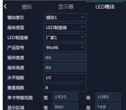
根据发送卡的单卡带载范围设置水平箱体数量和垂直箱体数量。
