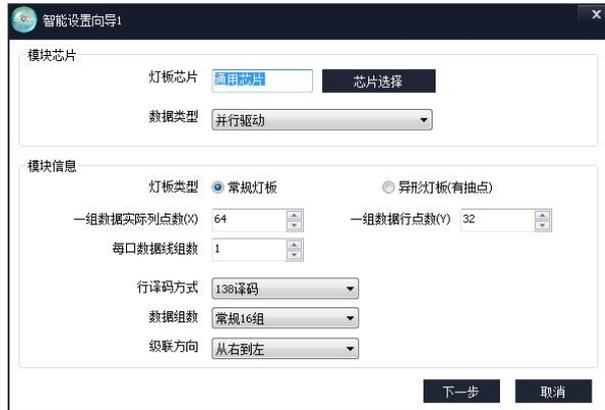
6、用户可将“显示屏变化”中自动变化的√去掉，点击1或2，并观察LED屏变化，选择“显示状态”。确定后点击“下一步”。
