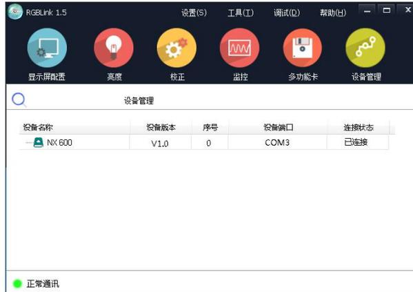
2、点击显示屏配置进入调试发送卡界面。首先确认电脑的分辨率一定要跟发送卡（处理器）分辨率调为点对点一致。发送卡设置完成后须点击“保存到发送卡”
