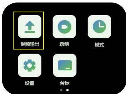
1.轻按【M】键进入主菜单后，轻触【视频输出】，对 HDMI/USB 输出进行设置
