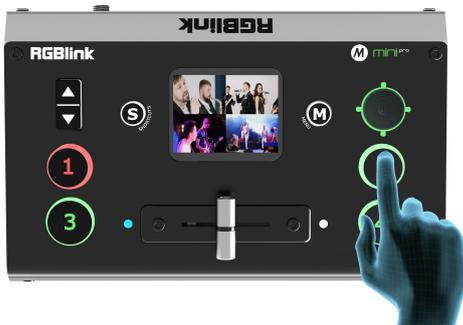
mini-pro 默认是 0.5 秒的淡入淡出直接切换模式，即通过轻按①②③④按键可以直接进行 4 路信号的快速淡入淡出切换
