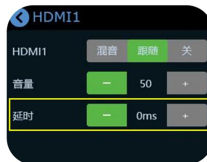
4.若音视频不同步时，可设置声音的延迟调节。一般情况下，MIC 的声音延迟会比 HDMI 的画面快约 100ms，所以默认可以调整 MIC 的延迟在 80-115ms 之间
