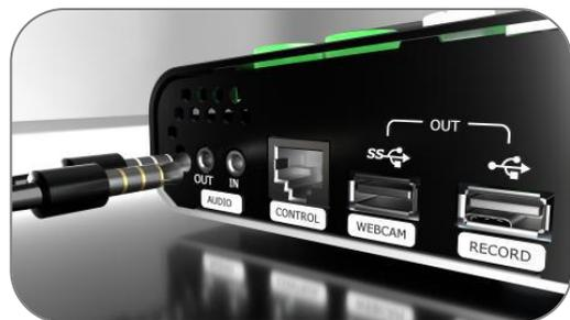
4.连接麦克风至 Audio IN 接口，连接音箱或耳机至 Audio OUT 接口
