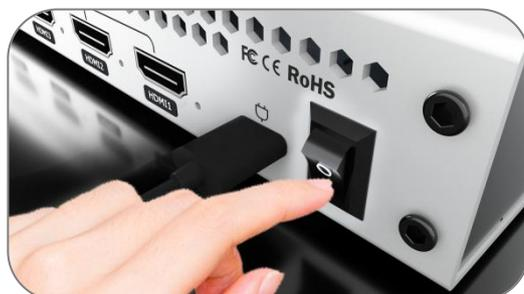
8.连接完输入输出后，轻按后面板上方的开机键，10 秒后设备进入开机界面
