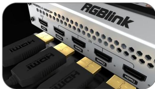
2.通过 HDMI 连接线将电脑、笔记本、摄像机或 DVD 等输入源连接至 mini-pro 的 HDMI IN 接口
