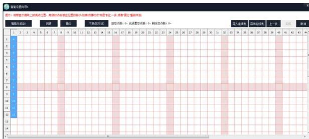
9、观察 LED 屏第一块模组上亮点的位置，用鼠标点击相应位置的格子；如果点错可以点击“后退”到上一步，或者“复位”重新开始。若第一步选择的是异形灯板，则需要描空点。观察第一块模组，如果不出现闪点就点击“不亮点（空点）”直到出现闪点。（无法确定空点的位置时，请不要快速描点，注意观察模组闪点变化。）
