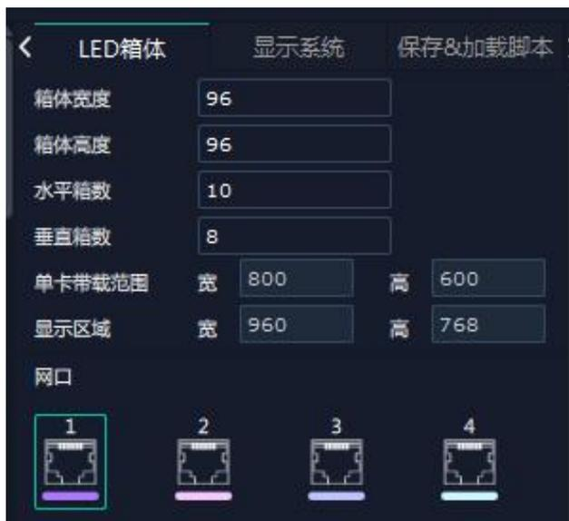
LED 箱体是指组成 LED 屏的基本单位。根据现场实际情况输入箱体的宽度、高度、水平与垂直箱体数。
