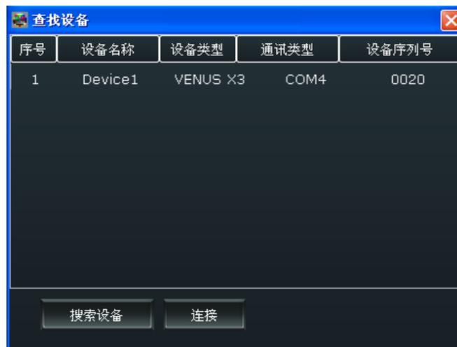
最后，选择设备类型，如下图所示，再点击“连接”，设备连接完成。
