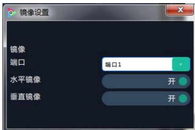
点击“镜像端口”对应的绿色下拉箭头，用户可以选择所有端口或是 4 个端口的任一端口。通过滑动开关启用或禁用水平镜像或垂直镜像效果。
