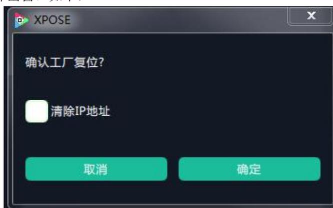
点击“确定”，设备将清除所有操作数据，恢复到出厂设置。
