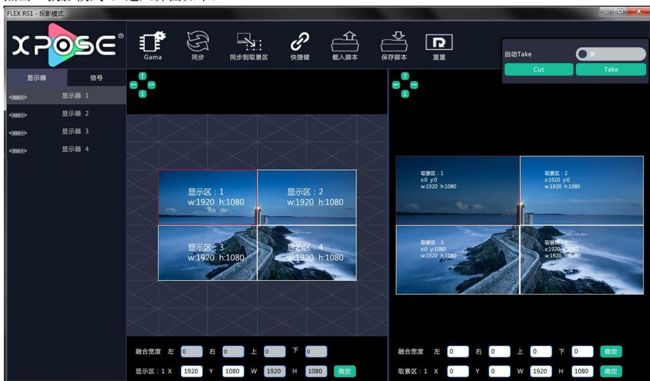
图层 1~4：“X”和“Y”表示图层位置，“W”和“H”表示图层尺寸大小。
