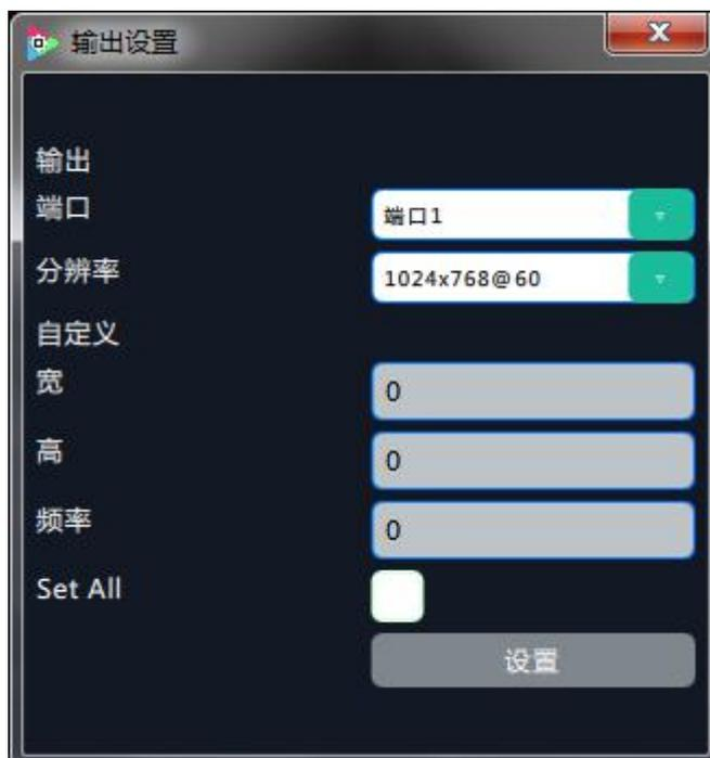
点击 “输出端口” 对应的绿色下拉箭头, 用户可以选择 4 个端口的任一端口。该模式允许独立设置每个端口的分辨率。
