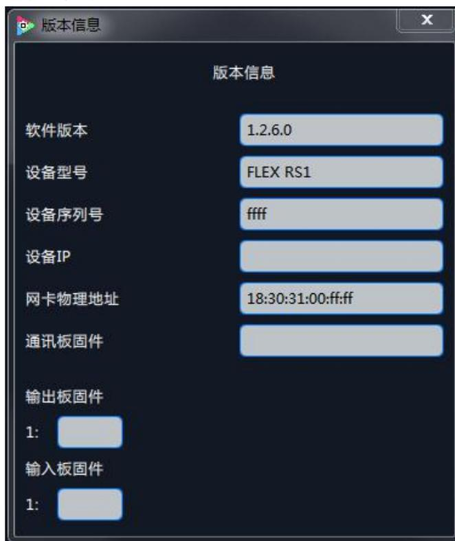
用户可查看当前设备的版本相关信息，包括软件版本、设备型号、设备序列号、设备 IP、网卡物理地址、通讯板固件、输出板固件及输入板固件的版本号。
