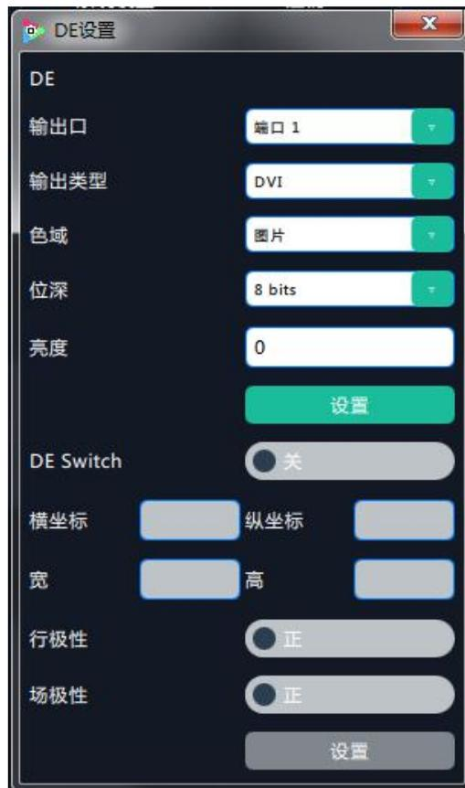
**DE:** 用户可选择某个或者所有输出端口，对输出类型、色域、位深和亮度进行设置，设置完成后，点击“设置”确认。并滑动开关选择打开 De 功能，设置包括横坐标、纵坐标、宽、高调整以及行极性和场极性的选择。
