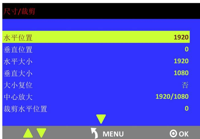
根据步骤 4 的信息，将水平大小设置为 11520，即  $1920 \text{ (PGM1)} + 1920 \text{ (PGM2)} + 1920 \text{ (SPGM1)} + 1920 \text{ (SPGM2)} + 1920 \text{ (SPGM3)} + 1920 \text{ (SPGM4)} = 11520$ 。图片或视频将输出到 AUX 六个拼接口中，如下图所示：
