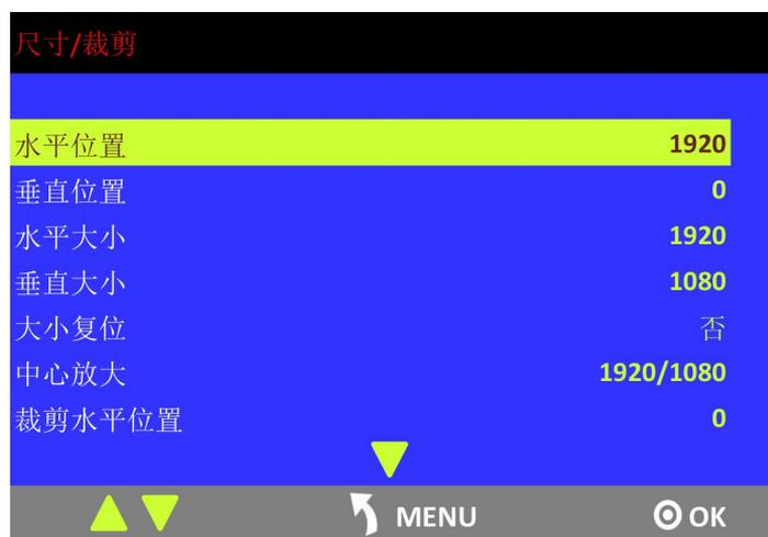
根据步骤 2 的信息，将水平大小设置为 9600，即  $1920 (PGM)+1920 (SPGM1)+1920(SPGM2)+1920 (SPGM3)+1920 (SPGM4)=9600$ 。图片或视频将输出到 AUX 五个拼接口中，如下图所示：
