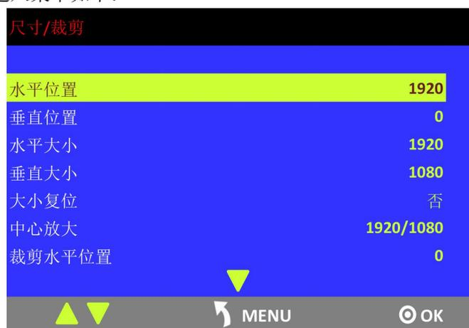
根据步骤 2 的信息，将水平大小设置为 3840，即  $1920 (SPGM1/3) + 1920 (SPGM2/4) = 3840$ ，并将垂直大小设置为 2160，即  $1080 (SPGM1/3) + 1080 (SPGM2/4) = 2160$ 。图片或视频将输出到 AUX 四个拼接口中，如下图所示：
