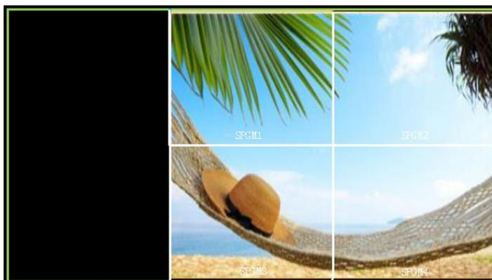
若要全屏显示，可将水平位置设置为 0，并将水平大小设置为 5760，即  $1920 \text{ (PGM)} + 1920 \text{ (SPGM1/3)} + 1920 \text{ (SPGM2/4)} = 5760$ ，并将垂直大小设置为 2160，即  $1080 \text{ (SPGM1/3)} + 1080 \text{ (SPGM2/4)} = 2160$ ，如下图所示：
