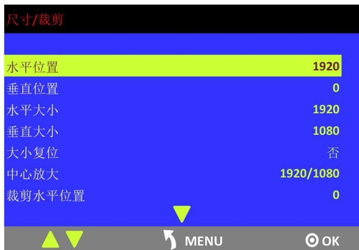
根据步骤 2 的信息，将水平大小设置为 7680，即  $1920 (SPGM1)+1920 (SPGM2)+1920 (SPGM3)+1920 (SPGM4)=7680$ 。图片或视频将输出到 AUX 四个拼接口中，如下图所示：
