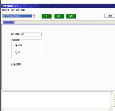
在下拉菜单中选择当前所使用的小型变换器型号。用户可以通过“串口设置”对串口号和串口波特率进行设置。通过下拉箭头用户可以选择当前所使用的串口，串口波特率应设置为115200。
