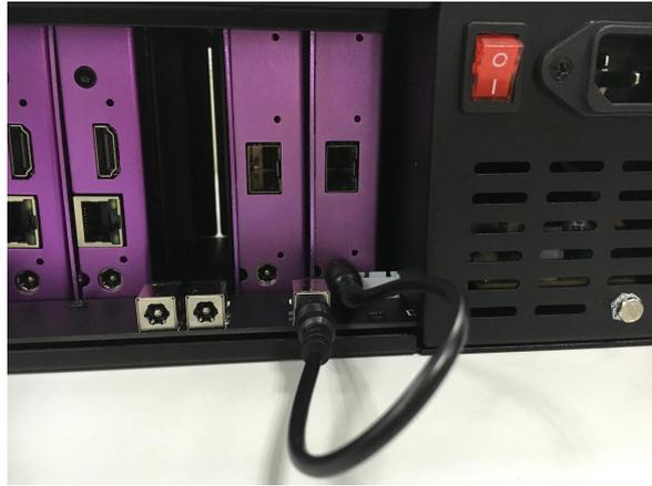
采用就近原则，依次将 DC 电源线连接到不同的小型转换器，最多可同时装配 10 个小型转换器；
