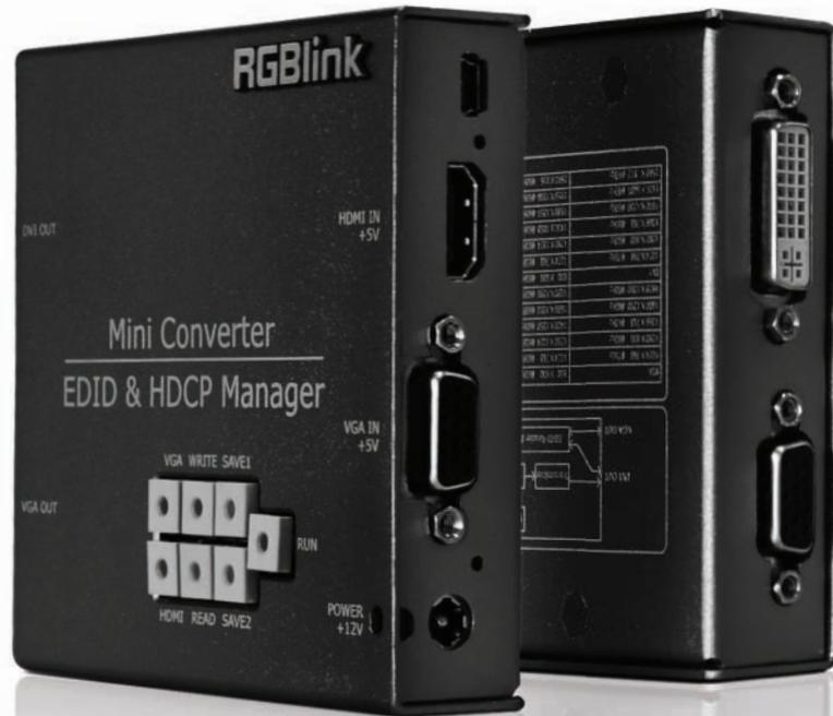
在现在一个数字信号的时代，MSP 221这款用于DVI, VGA 和HDMI信号源的EDID&HDCP管理器应境而生，其按照用户选择的分辨率和刷新率，将预先存储的EDID信息传送至信号源。或者也可以将MSP 221设置为在连接至显示设备时捕获并储存EDID信息。
